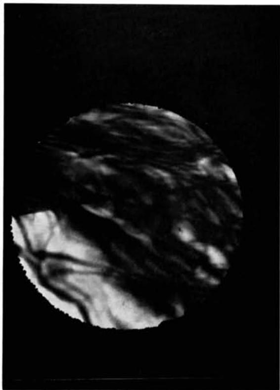
Fig. 7. Macle (111) dans  $B\text{-Sm}_2\text{O}_3$ ,  $\times 35000$ .
