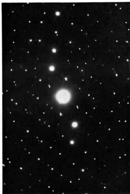
Fig. 10. Microdiffraction de part et d'autre du plan de macle  $(313)$ .
