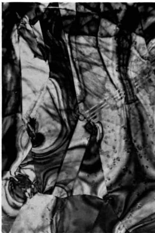
Fig. 9. Macles  $(1\bar{1}1)$ ,  $(313)$  et  $(3\bar{1}3)$  dans  $B\text{-Sm}_2\text{O}_3$ ,  $\times 35000$ .
