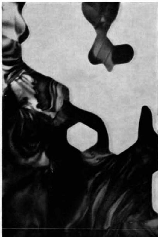
Fig.12. Trous de formes géométriques régulières dans la couche mince sous bombardement électronique prolongé ( $\times 35000$ ).
